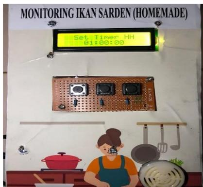
Gambar 7. Pengujian Push Button
