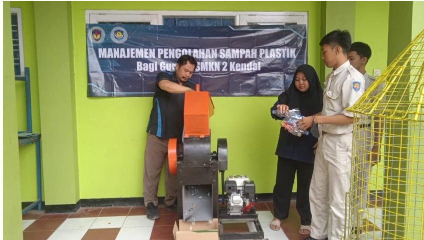
Gambar 5. Pengarahan penggunaan mesin pencacah plastik oleh guru kepada para murid SMKN 2 Kendal
