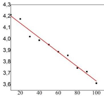
**Gambar 5.** Grafik tegangan keluaran sensor deteksi getaran kupasan jaket 0,5 cm
