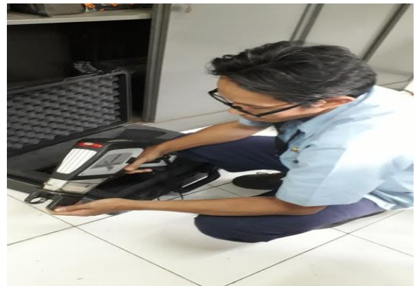
Gambar 9 : Proses pengambilan komposisi kimia crossjoint.
