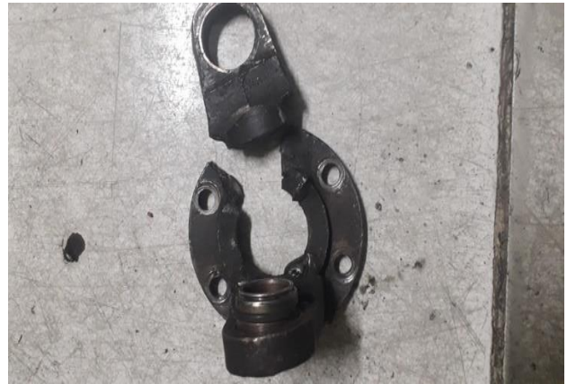
Gambar 4 : Bentuk kegagalan cross joint yang patah.
