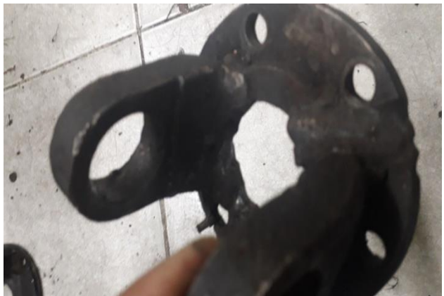
Gambar 5 : Bentuk kegagalan cross joint yang retak.
