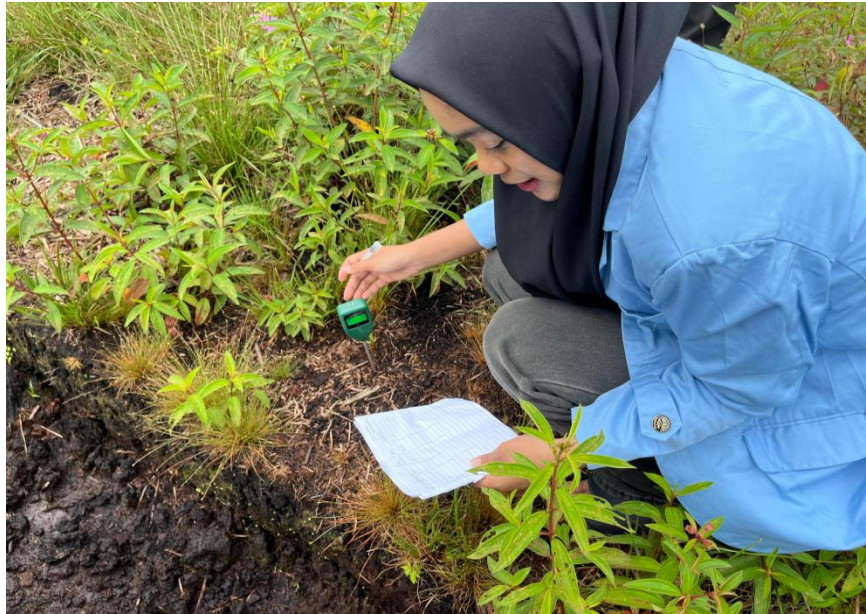
Gambar 1. Pengukuran pertilasi dan kelembabman tanah gambut.
