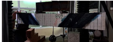
Gambar 8. Pola Keruntuhan BV2-2
