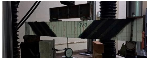
Gambar 7. Pola Keruntuhan BV2-1
