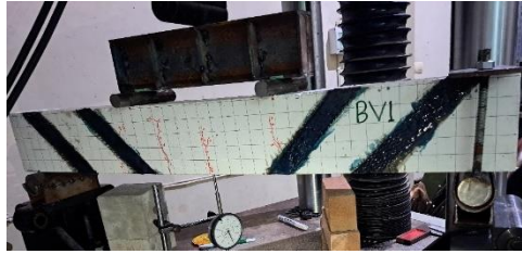
Gambar 5. Pola Keruntuhan BV1-1
