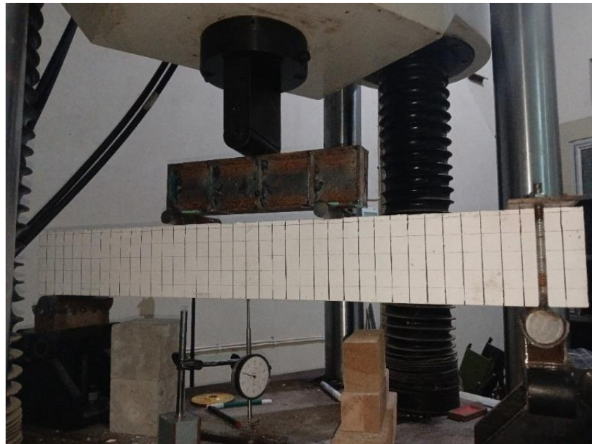
Gambar 2. Set Up Pengujian Balok Beton Bertulang
