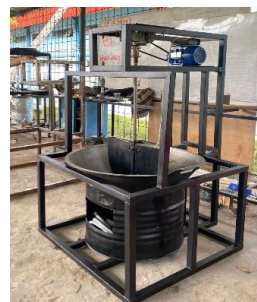
Gambar 3. Mesin Penyangrai Kacang Tanah
