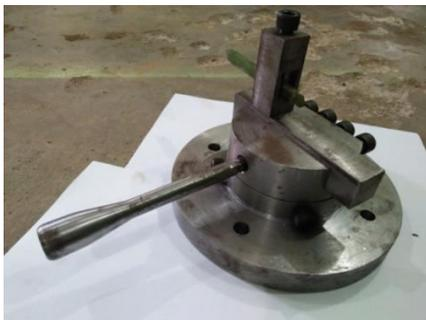
**Gambar 8.** Pasang *tool holder* pada *upper tool post*
