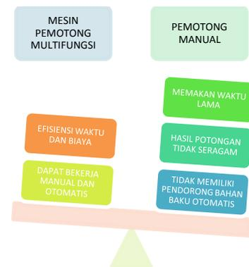
**Gambar 6.** Bagan Perbedaan antara mesin pemotong multifungsi dengan pemotong manual
