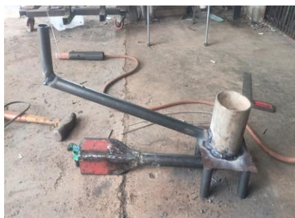
Gambar 5. Bentuk alat setelah finising dan siap untuk di uji kegunaan nya
