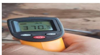
Gambar 3. Suhu yang di hasilkan kompor bahan bakar oli bekas
