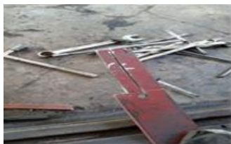
Gambar 6. Pembuatan Spesimen Uji Bending
