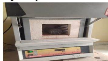
Gambar 13. Memasukkan Spesimen Kedalam Oven Pemanas
