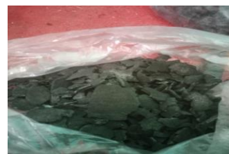
Gambar 9. Arang Carburizing Tempurung Kelapa
