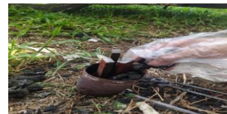
Gambar 11. Memasukkan Spesimen dan arang kedalam kaleng Carburizing
