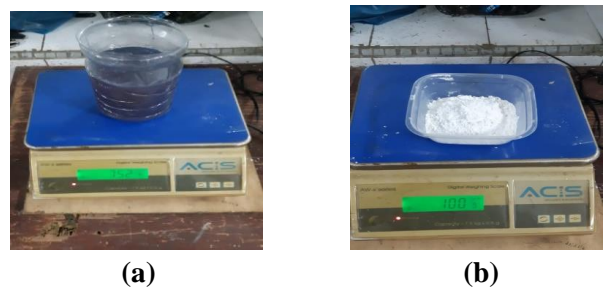
Gambar 3. a. penimbangan Resin, b. penimbangan magnesium
