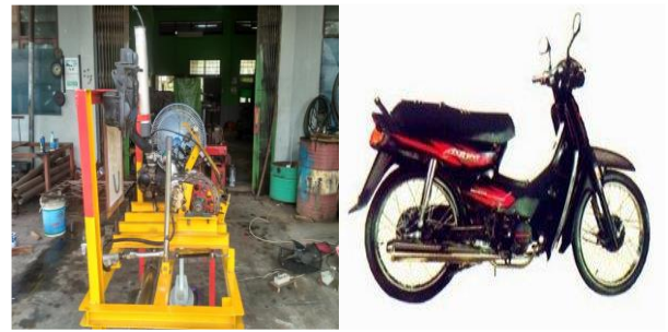
Gambar 1. Unit uji prestasi mesin sepeda motor honda astrea 100 cc
