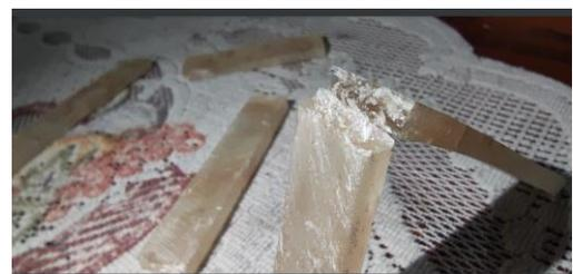
**Gambar 6.** Patahan komposit variasi serat 20% : resin 80%
