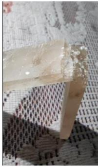
**Gambar 7.** Patahan komposit variasi serat 30% :
