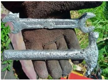
**Gambar 5.** Produk uji coba kupola pelebur logam
