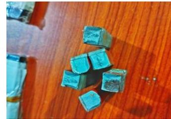
Gambar 4. Hasil Uji Patahan Spesimen
