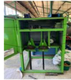
Gambar 4. Realisasi alat Pemotong Singkong, Kentang, dan Wortel
