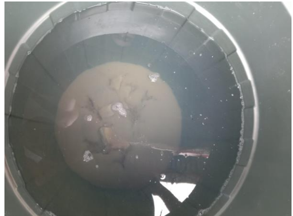
Gambar 4. Air yang sudah ditawas dan di endapkan selama +/- 15 menit
