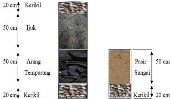
Gambar 2. Susunan media penyaringan
